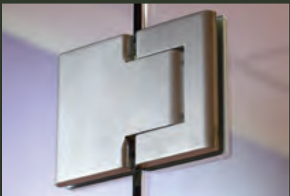
biloba 8015 jc pendeltürbänder Glas-Glas 180 ° Selbstschließendes Hydraulikband mit Dämpfung und Regelung der Schließgeschwindigkeit. Für Pendeltüren ohne oder mit Anschlag. Feststellung bei 90 ° Grundkörper komplett verkleidet mit zusätzlichen Abdeckungen aus Edelstahl V4 A Mit integrierter Nulllagenregulierung
